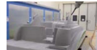
CNC-Usinage d'un pont de bateau fait avec de la pâte époxy SC175.
