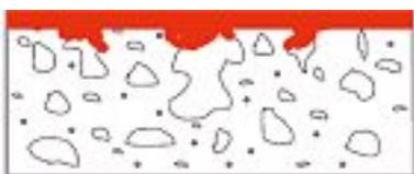
Ces produits de protection peuvent couvrir les Principes 1, 2 ou 8 de la norme NF EN 1504-9 (Principe 1 : Protection contre toute pénétration, Principe 2 : Contrôle de l'humidité et Principe 8 : Augmentation de la résistivité).
