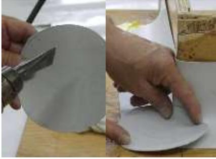
9. Chauffer et former la rondelle à l'aide de l'appareil à air chaud...
