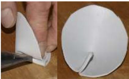
15. Chauffer le pli extérieur à l'aide de l'appareil à air chaud, serrer avec la main et souder.
