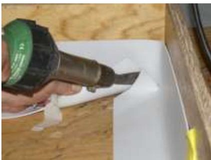
7. Souder ensemble les pans de la poche. Chauffer à l'aide de l'appareil à air chaud et presser ensemble avec les doigts. Eviter l'accumulation de chaleur vers l'angle.
