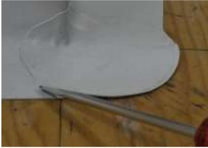
14. Une fois refroidi, les cordons de soudure peuvent être testés à l'aide d'un tournevis.
