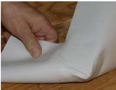
10. Après refroidissement, les cordons de soudure peuvent être testés à l'aide un tournevis ou d'une pointe sèche.
