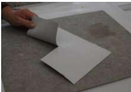
1. Couper un carré d'environ 30 cm x 30 cm de bande Sikadur-Combiflex SG ou SGT. Utiliser de préférence une bande de 2 mm d'épaisseur.
