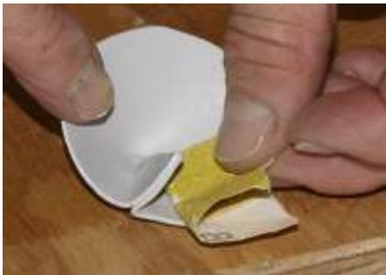
16. Poncer la surface de soudure dans le deuxième pli.
