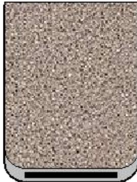
**Lamelles recouvertes par le tissu SikaWrap****Cas de lamelles ancrées avec la mèche SikaWrap® FX-50C**
