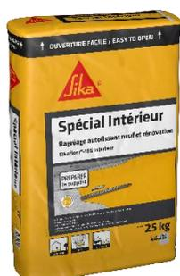
Sikafloor®-105 intérieur est un enduit de ragréage autolissant, de 1 à 10 mm, destiné à la préparation des sols intérieurs à faible sollicitation comme les chambres, séjours ou bureaux. Il peut être recouvert par de multiples revêtements de sol (carrelage, PVC, textile, parquet).
