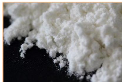
Des mesures réalisées selon un protocole spécifique ont démontré que l'utilisation de SikaFiber®-200 Végétal, à un dosage de 300 g/m<sup>3</sup>, permet une réduction de 68 % des fissures au jeune âge (24 heures) par rapport à un béton non fibré.
