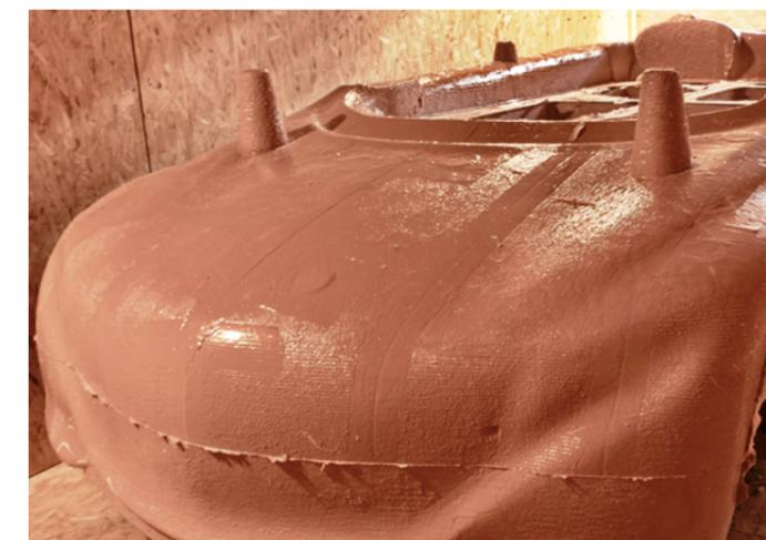
Des modèles volumineux peuvent être coulés en une seule fois et à l'échelle 1:1 grâce à notre résine Biresin® M67
