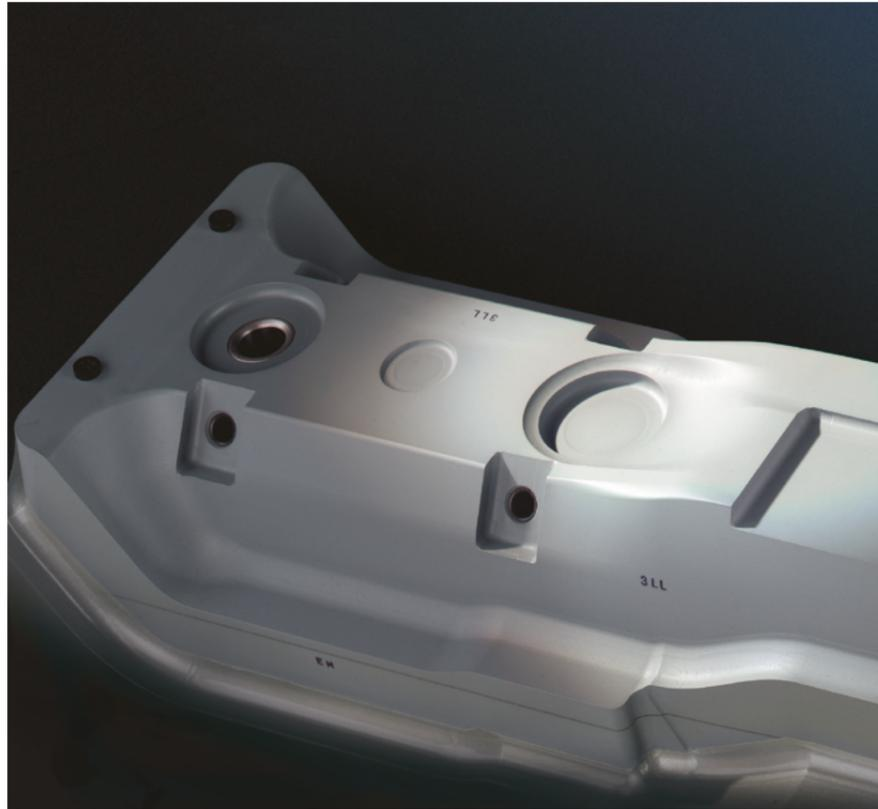
Calibre de haute précision dimensionnelle fraisé à partir de planches Prolab 75
