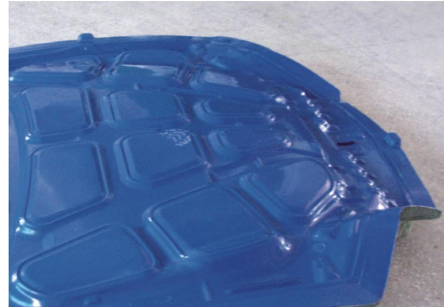
Outil pour renforcer les capots conçu avec le gelcoat GC1 080
