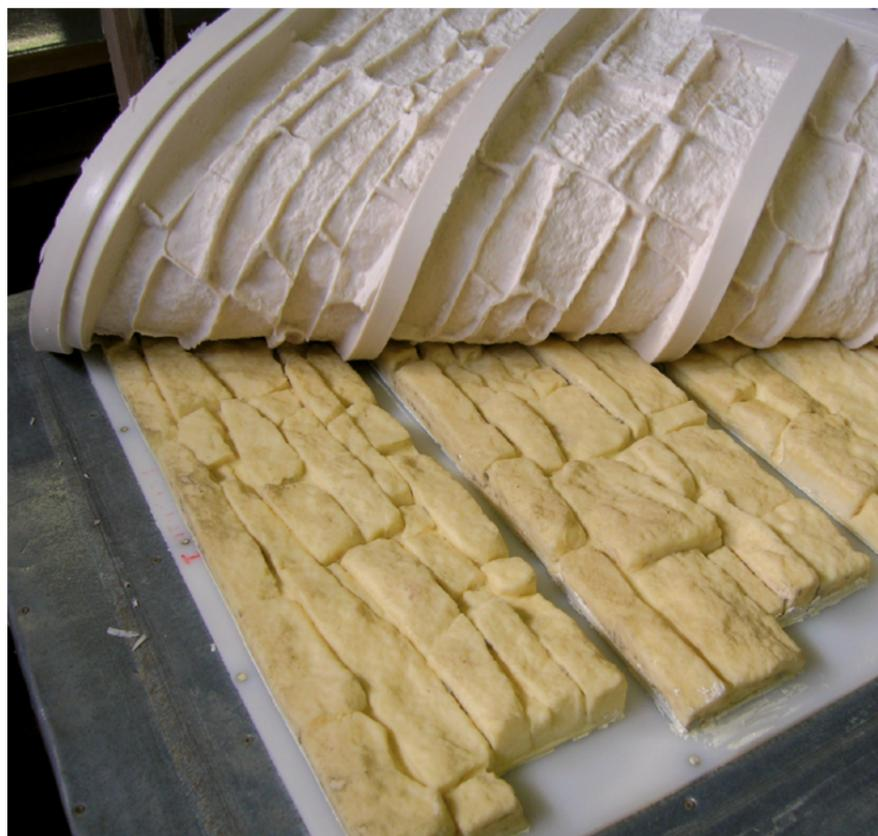
Démoulage d'un moule souple UR 58480 pour parement en pierre
