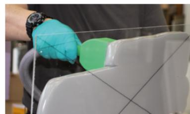
Le thixotrope SC175 permet une application verticale monocouche et sans coulure
