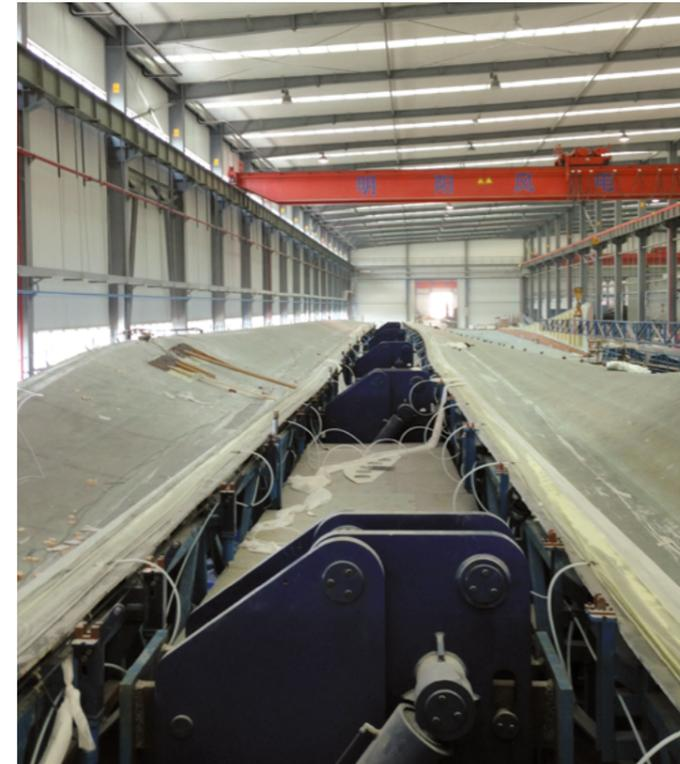
Moulage par infusion sous vide d'une pale d'éolienne avec Biresin® CR131
