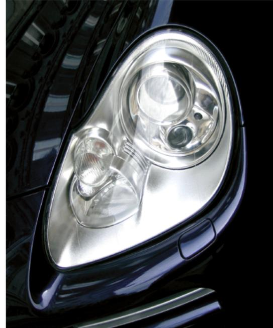
Lentille de phare avant réalisée avec PX 5212
