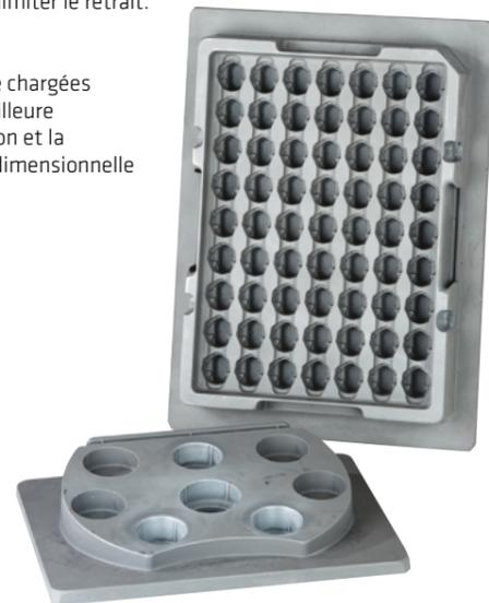
Moule de thermoformage sous vide pour conditionnement sous blister réalisé avec Biresin® G38
