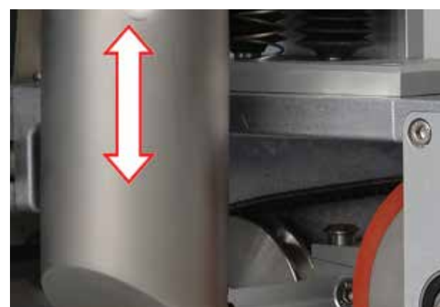
Buse suspendue pour la soudure sur des supports de planimétrie inégale.
