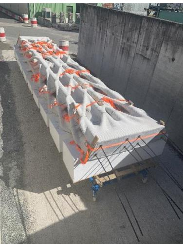
Sika a fourni le matériau (SikaCrete® 7100 3D : micro-béton multi-composants renforcé de fibres pour l'impression 3D) mais aussi l'expertise technique en construction imprimée 3D, avec la modélisation, le slicing d'objets et plus globalement d'évaluation de la faisabilité.
