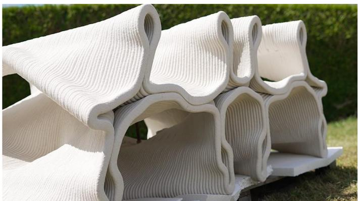
Diamanti est la preuve « vivante » et à échelle 1 :1 que les avancées scientifiques et techniques dans le domaine des structures imprimées en béton 3D et renforcées par précontrainte, peuvent
