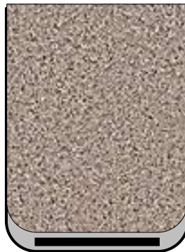
Figure 7 : Lamelles recouvertes par le tissu SikaWrap
