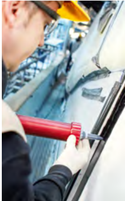
Application de la colle sur le cadre
