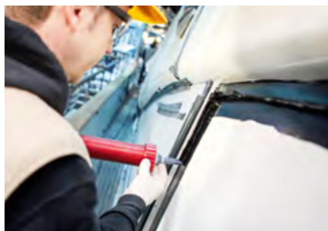
Application de la colle sur le cadre
