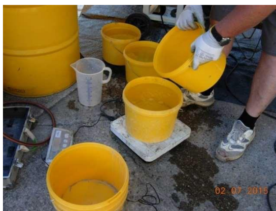
Figure 5 : Mesure de la quantité d'eau
