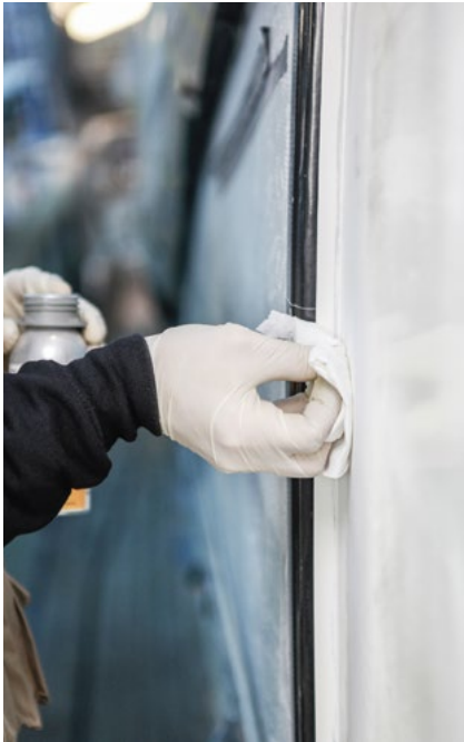
Préparation de la zone sérigraphie céramique avec Sika® Aktivator-100
