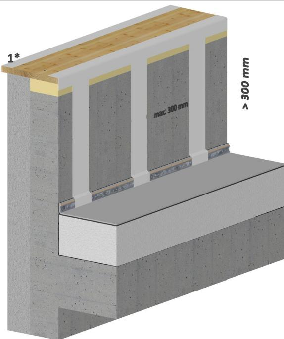
1\* SikaRoof® Adhesive Tape PVC ne doit pas être utilisé sous une bande de rive ou sous une bande de serrage qui doit être fixée mécaniquement.
