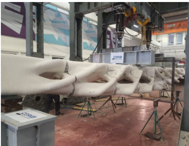
Photographie de l'essai sur poutre Diamanti d'environ 10 m de long réalisé au CERIB (© CERIB)
