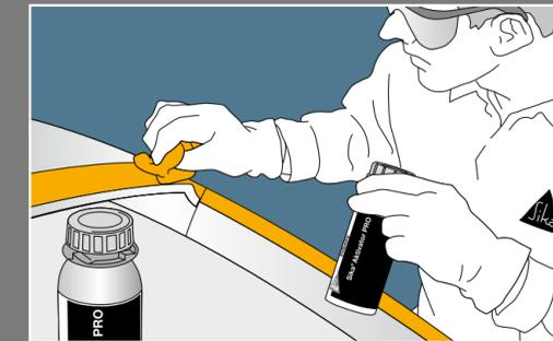
Appliquer Sika® Aktivator PRO sur la baie à l'aide d'un chiffon non pelucheux en une fine couche et en un seul passage. Temps de séchage : 3 minutes (- 10°C < T < 45°C).
