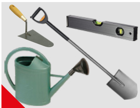
Outils nécessaires : Pelle, truelle, arrosoir, niveau
