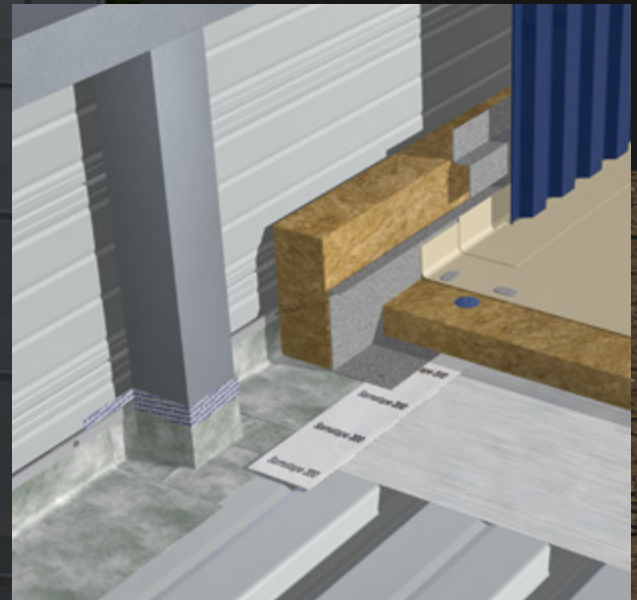
Fermeture autour des baionnettes et poteaux
