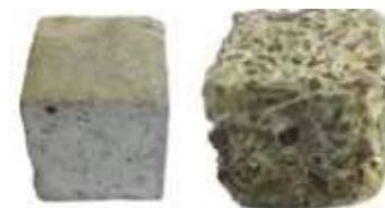
**Fig. 11 :** Cube de mortier 100% CAC placé dans la chambre de simulation de Hambourg [6] pendant 1 an. La photo de gauche a été prise au début de l'étude, celle de droite un an plus tard.
