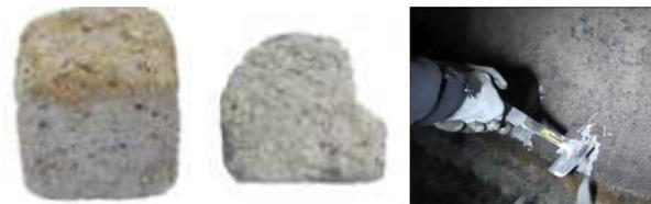
**Fig. 6 & 7 :** Mortier OPC contenant des cendres volantes, des fumées de silice et utilisant du sable de silice après 1 an en chambre d'incubation simulant la corrosion biogénique ; la photo de gauche montre le cube au début du test, celle du milieu, 1 an après (3).
