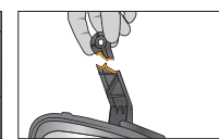
Réparation/reconstruction de pattes de phare
