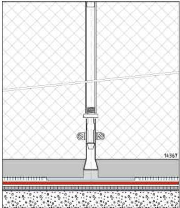
1. Souder par points la base de la bride sur la membrane à l'aide d'un outil de soudure à air chaud.
