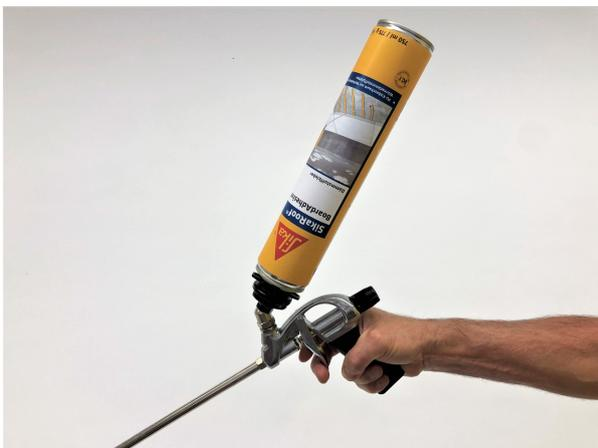
6. Appliquer SikaRoof® Board Adhesive directement sur la surface, puis positionner rapidement le panneau isolant sur la colle en exerçant une légère pression tout en ajustant sa position si nécessaire. Utiliser l'entretoise noire en bout de pistolet pour assurer la bonne distance entre la buse et le support d'application.
